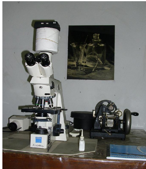
Fig 7. Microscopio Zeiss Axioskop y Micrótomo Reichert tipo Minot
